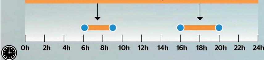
**Pendant les événements de pointe,** les éléments électriques se désactivent automatiquement, ce qui diminue la demande en électricité. La maison est ainsi chauffée par la chaleur accumulée dans les briques.
